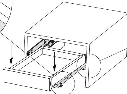
3. 3.1 Закрепите фиксаторами подвижные элементы направляющих с боковыми стенками ящика.
