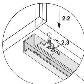
2. Установка ящика и регулировка фасада.
